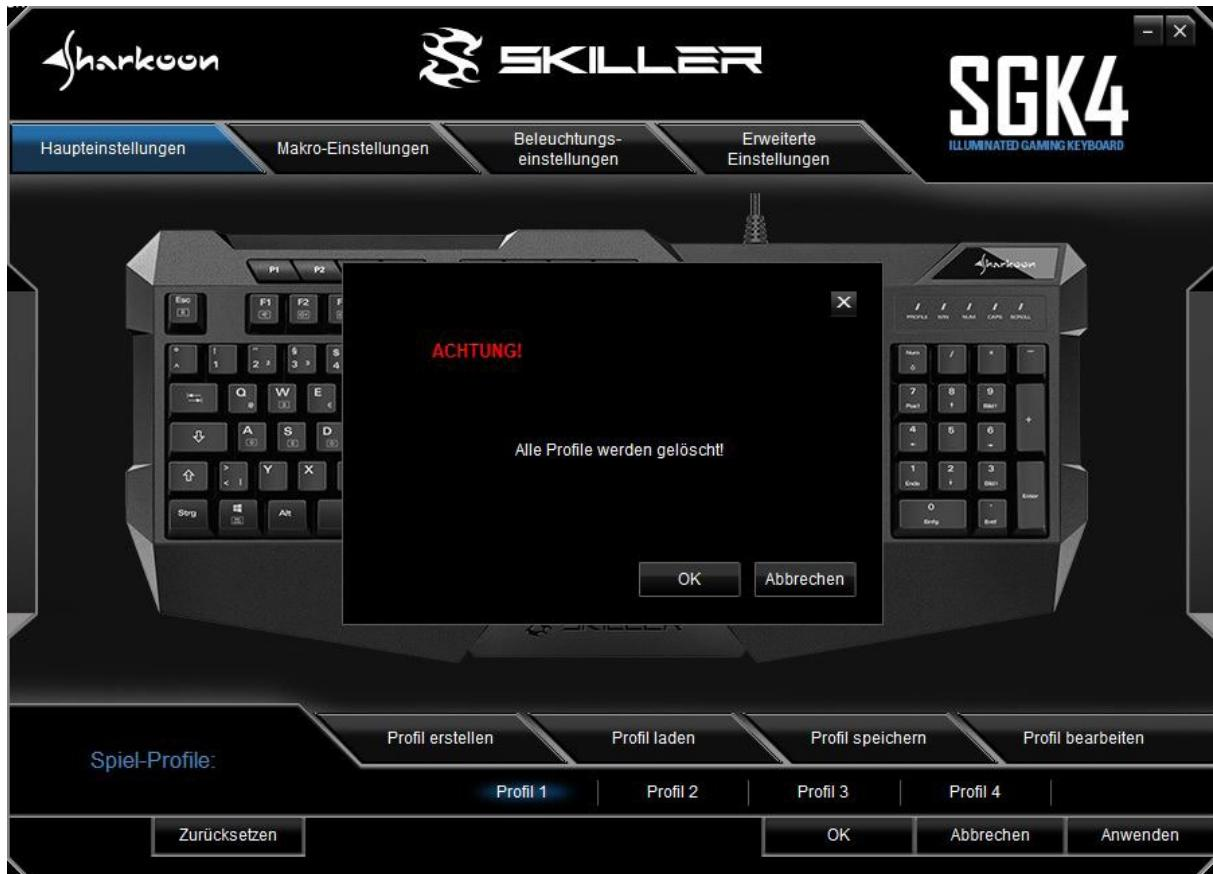
Mit der überall in der Software erreichbaren Schaltfläche „Zurücksetzen“ werden die im Onboard-Speicher der Tastatur geladenen Spiel-Profile (P1 - P4) auf Werkseinstellungen zurückgesetzt. Auf dem PC gesicherte Spiel-Profile sowie erstellte Makros sind von diesem Vorgang nicht betroffen und bleiben erhalten.
