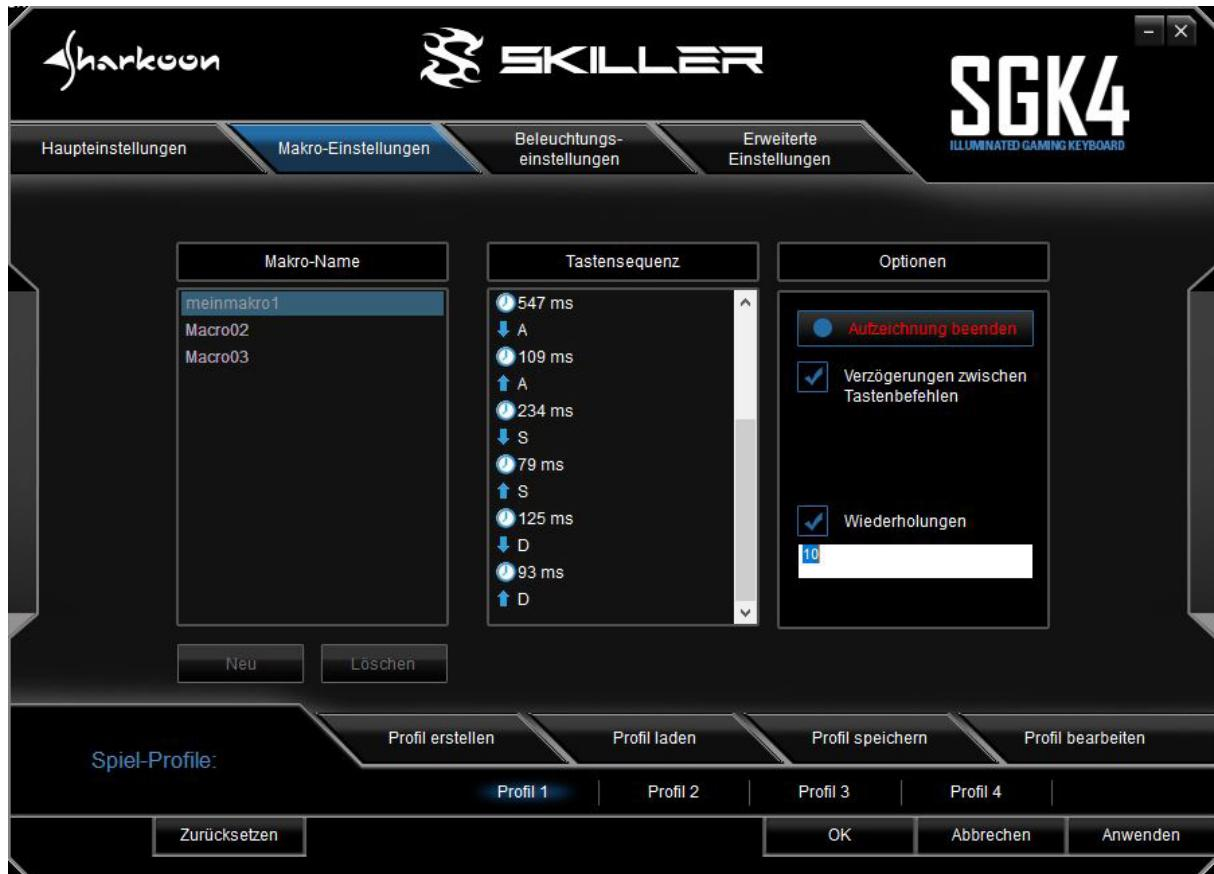
Wählen Sie das erstellte Makro aus und klicken Sie im Feld „Optionen“ auf „Aufzeichnung starten“, um eine Tastensequenz mit bis zu 50 Tastenbefehlen aufzunehmen.
